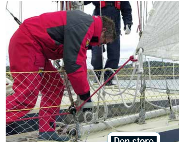
FOKKESLØR: På fokkeslør er det om å gjøre å få skjøtpunktet lengre ut og lengre frem. For å få til det, festet Christen en kasteblokk ute i rekka. Det man oppnår er å få mer kontroll over akterliket av genuaen, slik at spalten mellom seilene blir jevnere. Legg merke til avstan-den mellom genuaens skjøthjørne og bommen og kurven på genuaens akterlik. På bildet til høyre er genuaen skjøtet med kasteblokk ute i borde.
