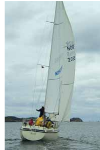
FOKKESLØR: På fokkeslør er det om å gjøre å få skjøtpunktet lengre ut og lengre frem. For å få til det, festet Christen en kasteblokk ute i rekka. Det man oppnår er å få mer kontroll over akterliket av genuaen, slik at spalten mellom seilene blir jevnere. Legg merke til avstan-den mellom genuaens skjøthjørne og bommen og kurven på genuaens akterlik. På bildet til høyre er genuaen skjøtet med kasteblokk ute i borde.
