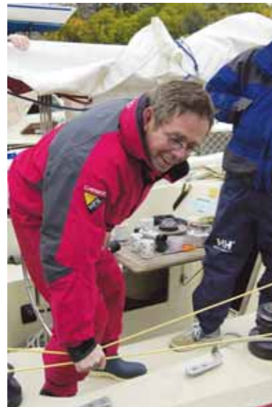
REKKEVAIERE: – Disse rekkevaierne er for slakke, påpeker Christen. Den øvre skal være stram, mens den nedre skal være slakkere, men ikke slakkere enn at den kan bøyes ned maksimum 5 cm mellom rekkestøttene.
