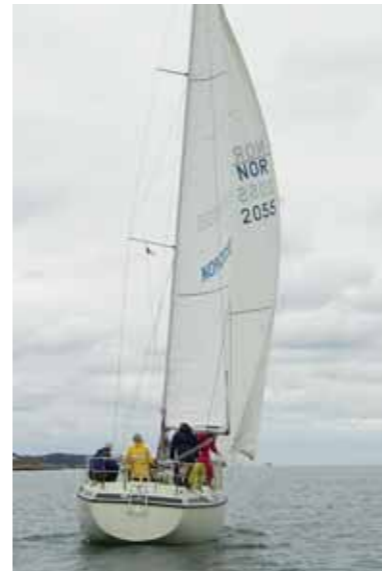
FOKKESLØR: På fokkeslør er det om å gjøre å få skjøtpunktet lengre ut og lengre frem. For å få til det, festet Christen en kasteblokk ute i rekka. Det man oppnår er å få mer kontroll over akterliket av genuaen, slik at spalten mellom seilene blir jevnere. Legg merke til avstan-den mellom genuaens skjøthjørne og bommen og kurven på genuaens akterlik. På bildet til høyre er genuaen skjøtet med kasteblokk ute i borde.
